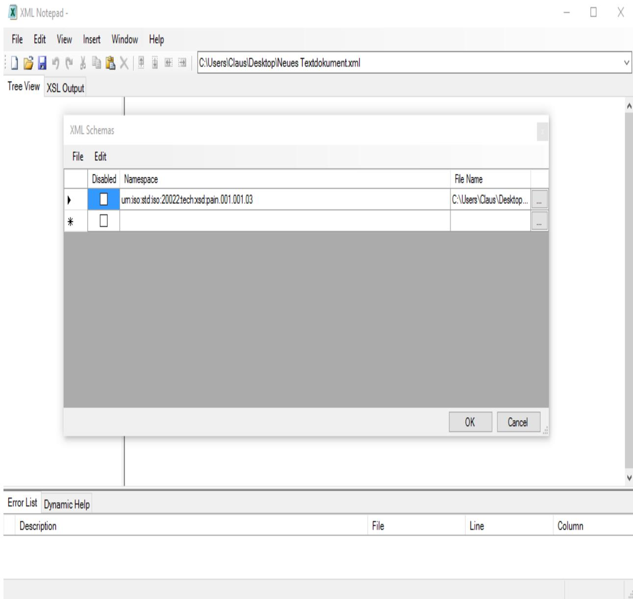
Im Anschluss wählen Sie die SEPA-Datei aus die gegen das Schema geprüft werden soll und öffnen diese im XML-Editor. Bei der Validierung gegen das XSD-Schema wird geprüft ob alle Inhalte in der XML-Datei korrekt abgebildet sind. Mögliche Fehler werden erkannt und in einer Fehlerliste dargestellt. Die nachfolgende Beispieldatei ist vom Aufbau korrekt, bzw. es wird kein Fehler aufgezeigt.
